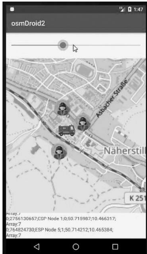
Abbildung 4: Prototypische Smartphone-Anwendung zur Darstellung der Position der Einsatzkräfte, anhand der im Netzwerk übertragenen Positionsinformationen
