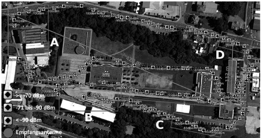
Abbildung 3: Ergebnisse der Reichweiten-Untersuchungen an der Hochschule Schmalkalden mit 25 mW Sendeleistung
