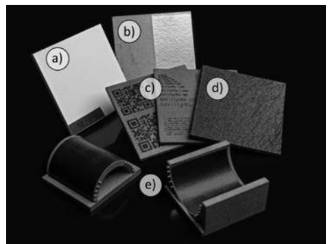
Abbildung 2: Gefinishte Bauteile: a) pulverbeschichtet, b) metallisiert, c) laserstrahlbeschriftet, d) laserstrahltexturiert, e) 3D-laserstrahlpoliert
