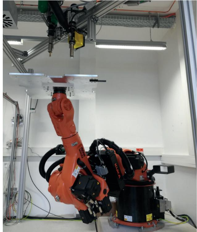
*Darstellung der experimentellen Anlagentechnik für das additive granulatbasierte Schmelzschichtverfahrens*
