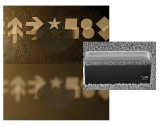
**Links:** Zwei Aufnahmen einer optischen Platte mit unterschiedlicher Fokussierung. Die zentrale Fläche wurde einseitig mit "Mottenaugenstrukturen" entspiegelt, wodurch die Reflexion in diesem Bereich stark reduziert ist. Im Gegensatz dazu zeigt die nicht entspiegelte Unterseite des Substrats deutliche Reflexionen
