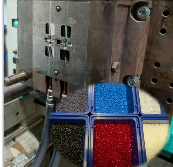
*Darstellung eines Spritzgusswerkzeuges für die Implementierung eines Multisensorsystems für den Digitalen Zwilling (Foto: Andreas Hopf)*
