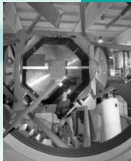
Lutz Freytag schwang den Hammer, um die Eigenschwingungen des Teleskopes zu messen. Foto: Kasper
