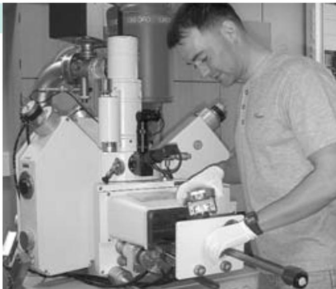
Dipl.-Ing. (FH) Jan Dellith beim Einschleusen einer zu untersuchenden Probe in den Elektronenstrahl-Mikroanalysator am IPHT Jena.
