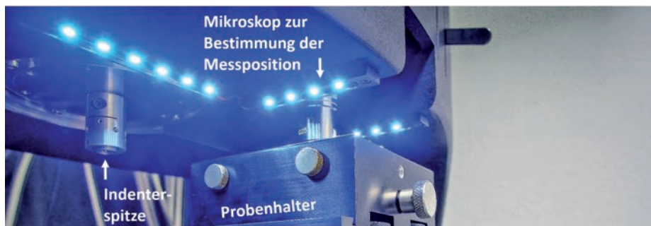
Abb. 1: Blick in den Nanoindenter G200. Nach der Positionierung der Probe unter einem optischen Mikroskop wird die Probe zur Messung automatisch unter die Indenterspitze gefahren. Foto: Maik Kunert
