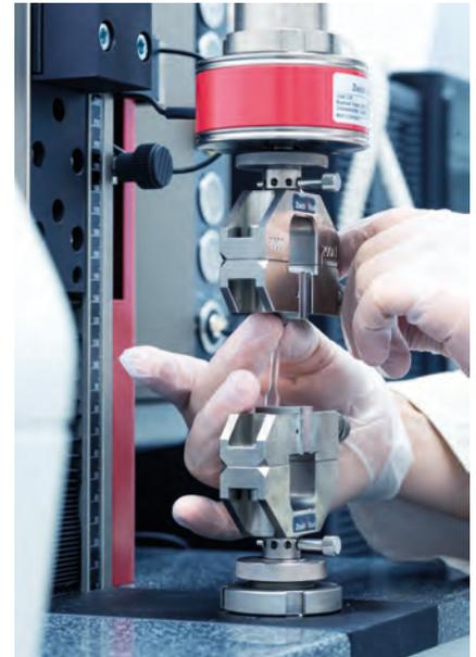
Arbeiten an einer Prüfmaschine zur Ermittlung von Werkstoffkennwerten an der EAH Jena; Foto: Sebastian Reuter
